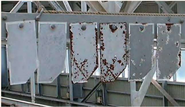
堆肥舎内での曝露試験(北海道士別市)
