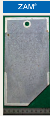
端面部の赤錆なし
