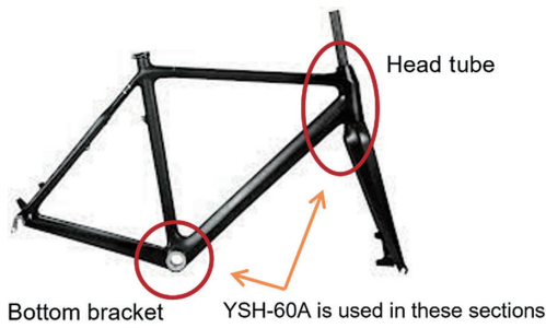
図6 ロードバイクフレームへのYSH-60Aの適用事例 Example of using YSH-60A fiber to stiffen ultralight road bicycle frames
