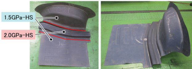
図 11 二軸ホットスタンプ工法を適用した部品試作結果 Prototype by developed method
