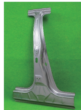
図6 一体センターピラー試作品 4) Prototype of center pillar
