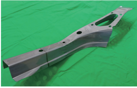
図 12 一体リアサイドメンバー試作品 Prototype integrated rear side member
