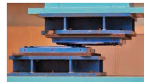
【水平移動時の変形状況 (実験状況)】
