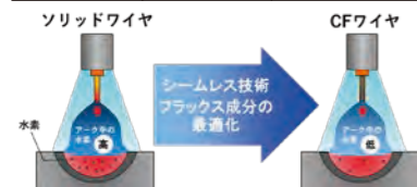
【拡散性水素低減の原理】
