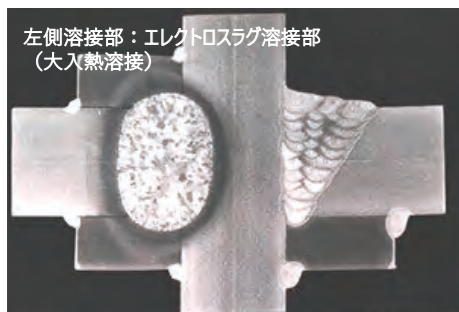
四面溶接ボックスのダイヤフラム溶接（SESNET）
