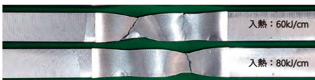
【継手引張試験の破断写真】 母材：SN490B
