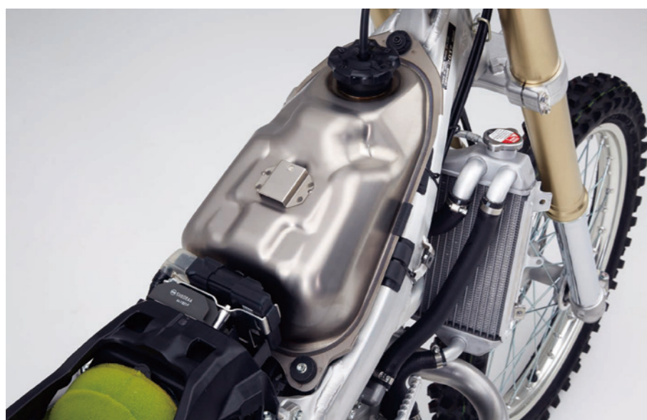
■ HONDAオフロードバイク「CRF450R」燃料タンクに採用 (TP270C)
