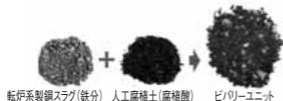
転炉系製鋼スラグ(鉄分) 人工腐植土(腐植酸) ビバリーユニット
