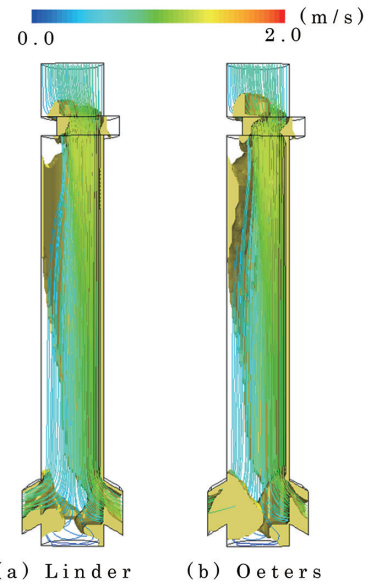
図9 Linder モデルと Oeters モデルによる流速分布 Distribution of fluid flow in Linder model and Oeter model
