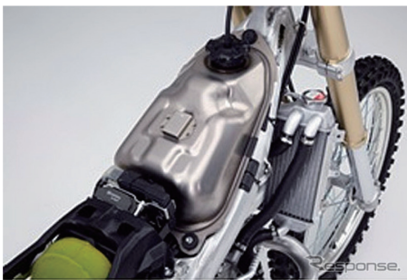
写真2 HONDA CRF450R チタン製燃料タンク Titanium fuel tank for HONDA CRF450R
