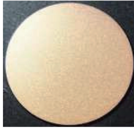
図12 光学顕微鏡にて観察した陽極酸化した対象材(ND材) View of titanium plate with oxide layer (ND)
