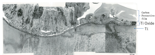
写真2 エコチターニャ®断面の透過電子顕微鏡 (TEM) 観察結果 Cross-sectional TEM microphotograph of ECOTitana™
