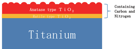
図2 エコチターニャ® 断面の模式図 Schematic diagram of cross-section of ECOTitana™
