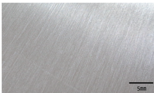
図9 電気めっきラインで製造したヘアライン加工Zn-Niめっきの外観 Appearance of hairline-processed Zn-Ni plating manufactured on an electroplating line
