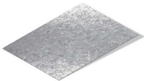
図1 スパングル模様溶融亜鉛めっき鋼板の外観 Photograph of a galvanized steel sheet with spangle texture
